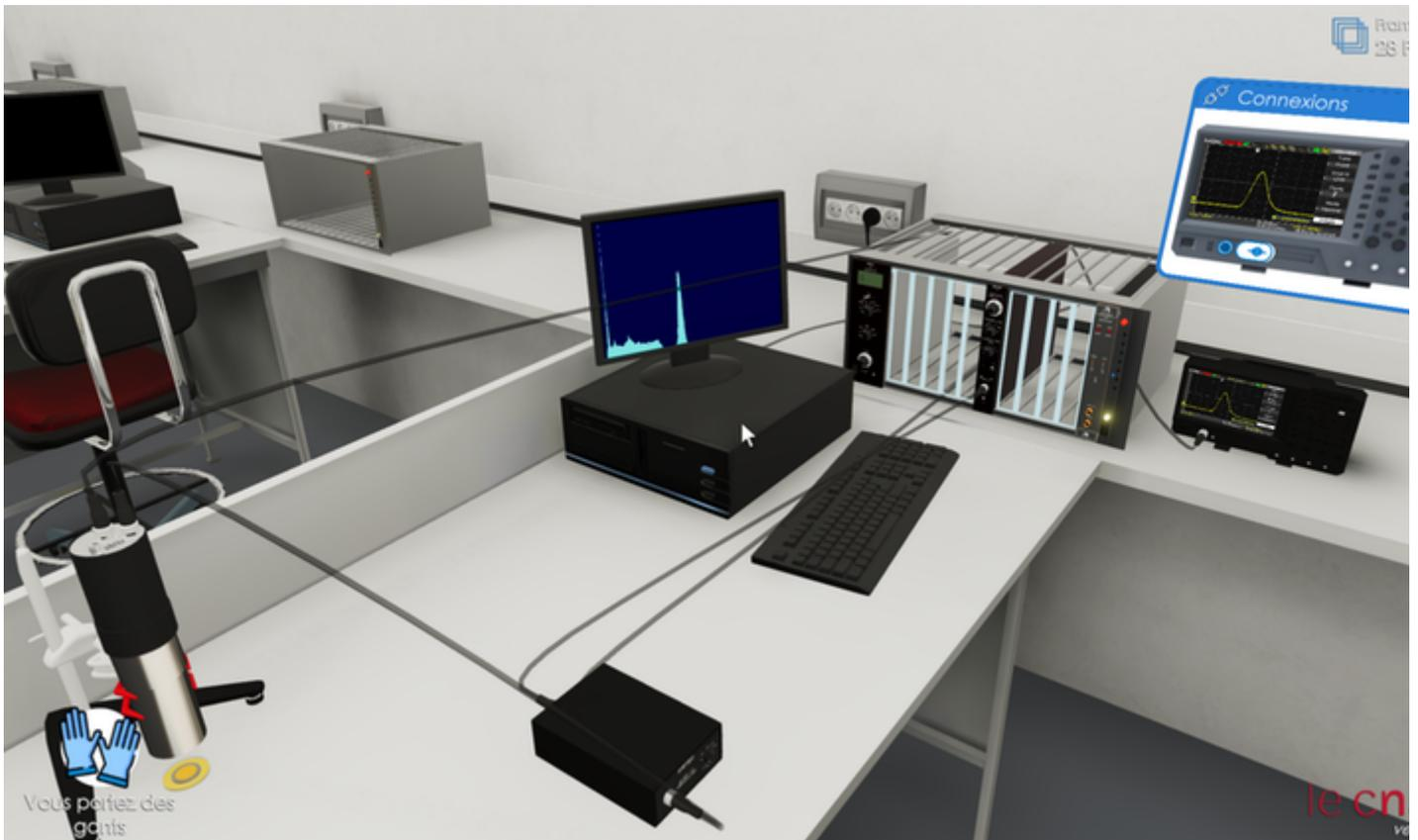
La réalité virtuelle est utilisée par les étudiants du CNAM pour se former à l'instrumentation nucléaire. Ici une chaîne de mesure entièrement virtualisée. Emmanuelle Galichet, Fourni par l'auteur
